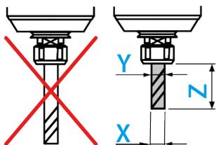
**Il diametro di taglio dell'utensile (X) non deve essere superiore all'intervallo di serraggio massimo (Y).**
